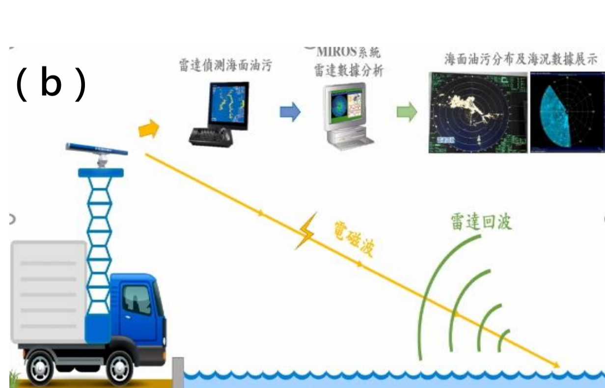
圖3. (a) 機動雷達車與 (b) 海面回波油污分析
