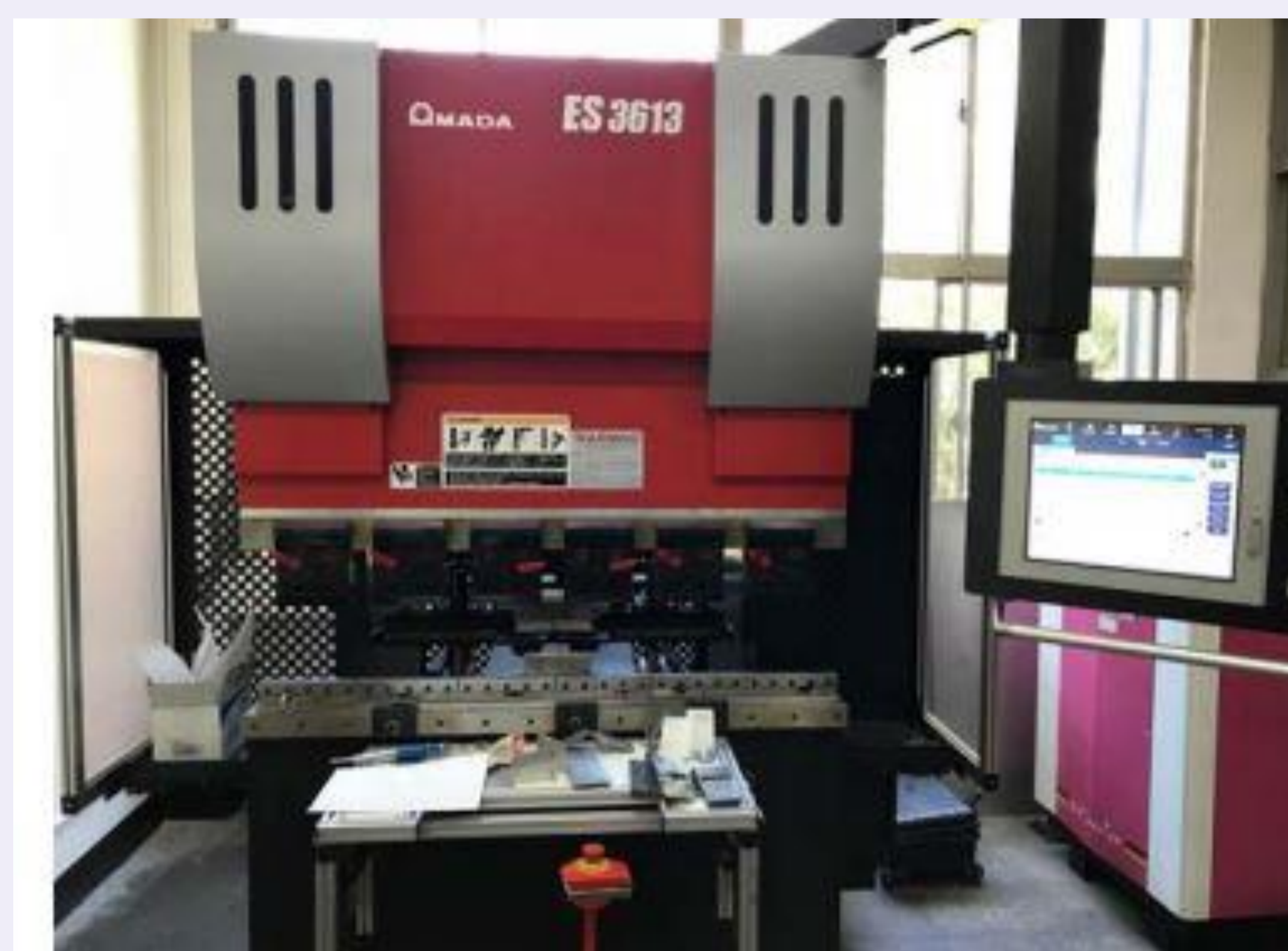
中心提供產業級設備 (Japan Amada ES3613 電腦數位控制折床)
